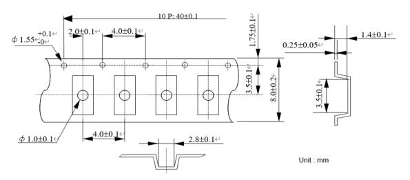
(2-2) Reel dimensions リール寸法 Reel Material リール材質: PS
