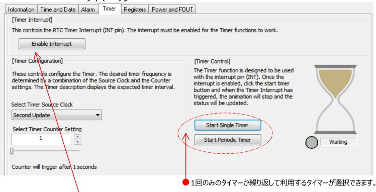
Enable Interrupt ボタンを押してください。Enable/Disable表示がトグルします。 Disable表示の時だけ、タイマー動作とアニメーションが有効になります。
